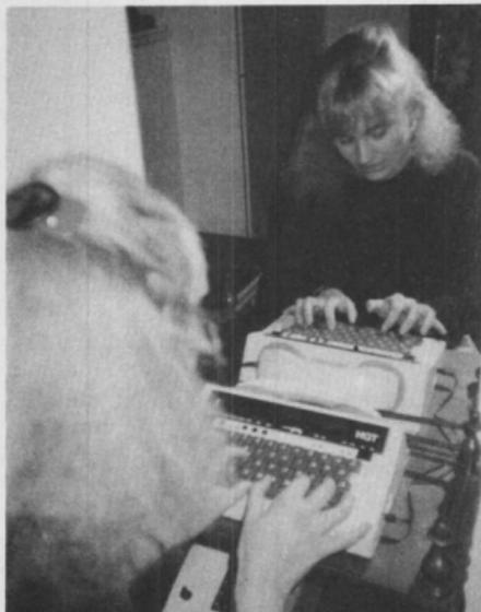
*Das Schreibtelefon ist im Prinzip ein kleiner Fernschreiber, der die Kommunikation mit anderen Besitzern eines solchen Gerätes ermöglicht (derzeit etwa 5.000).*
